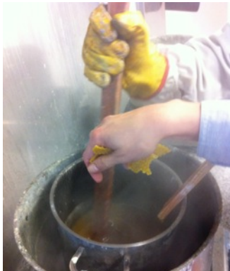
3. Después que la resina se disuelva, añadir la cera.
