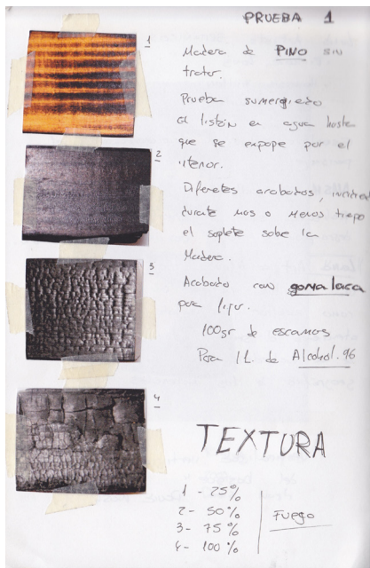
Fig. 14 Estudio de la carbonización en madera.
