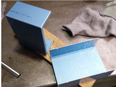
ILUSTRACIÓN 33 DETALLE CAJA PCB DURANTE SU ACONDICIONAMIENTO
