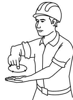
12 AVANZAR EN LA DIRECCION INDICADA POR EL SEÑALISTA
