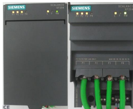
FIGURA 20: SWITCH SCALANCE Y CONEXIONADO
