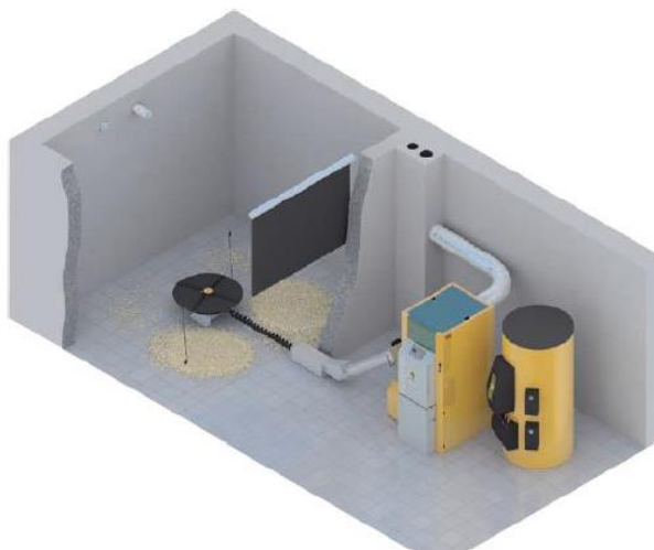
Figura 35: Esquema de instalación, con punto de suministro.
