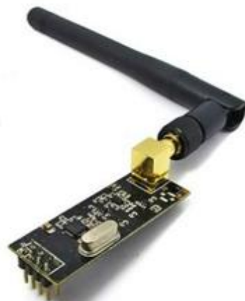
Figura 22 - Módulo de radiofrecuencia NRF2401 con antena integrada
