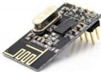
Figura 21 - Módulo de radiofrecuencia NRF2401 con antena externa
