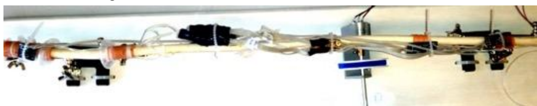
Figura 43 - Sistema de monitorización colocado sobre el Endoworm 3.0.
