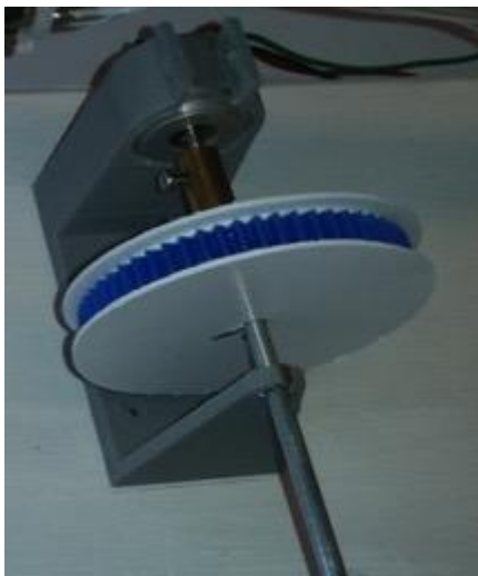
Figura 49 - Conjunto de sensor, soporte y rueda dentada modificada
