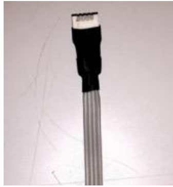
Figura 9 -Sensor de presión soldado y reforzado con tubo termoretráctil
