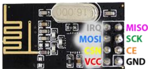
Figura 23 - Pines de conexión módulo de radiofrecuencia NRF2401
