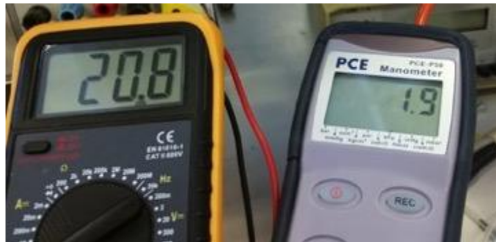
Figura 15 - Fotografía tomada en el proceso de calibración del sensor de presión. A la izquierda el multímetro y a la derecha el manómetro digital
