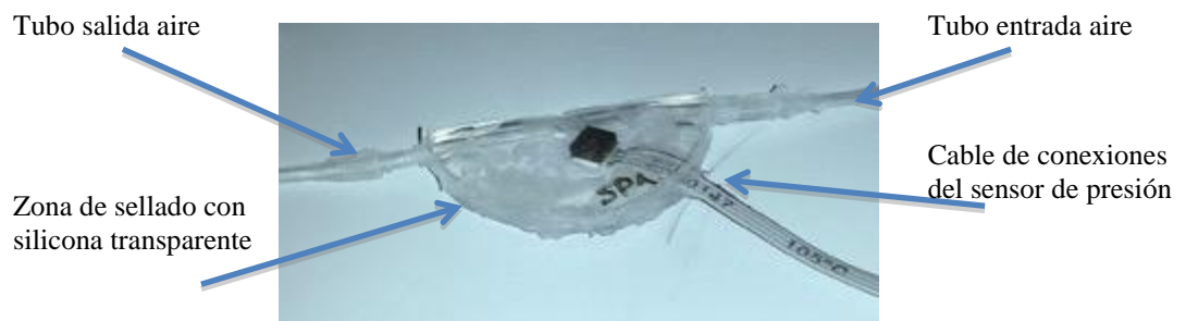
Figura 11 - Sensor de presión encapsulado
