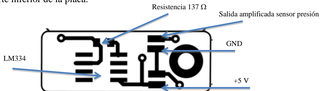
Figura 29 - Parte inferior placa sensor de presión
