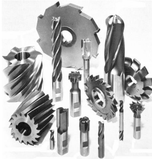
Ilustración 66: Variedad herramientas fresado
