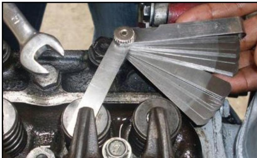
Ilustración 12 - Juego de galgas en reglaje de válvulas
