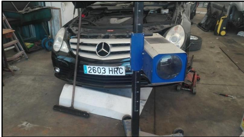
Ilustración 23 - Regloscopio para reglaje de faros
