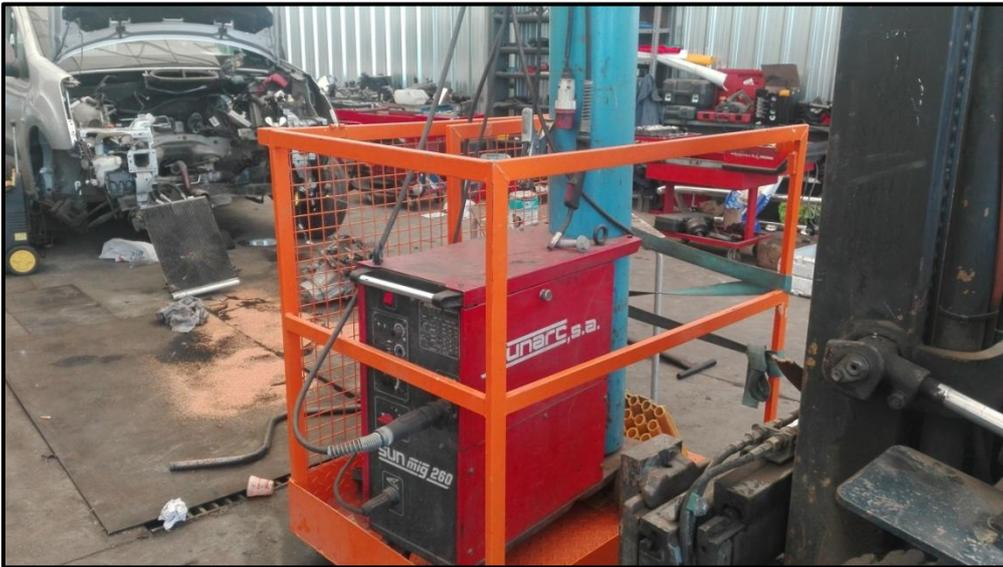
Ilustración 19 - Equipo de soldadura MIG
