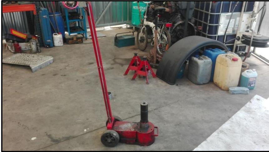
Ilustración 26 - Gato neumático
