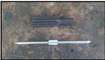
Herramienta 7 - Destornilladores punta intercambiable
