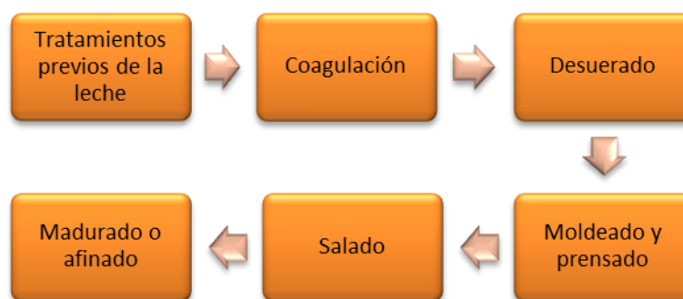
Figura 2. Esquema general del proceso de fabricación de queso
