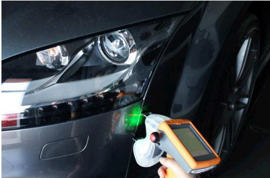
Figura 20. Operario midiendo con un Hand Held
