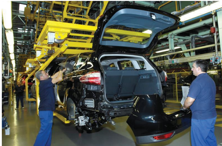
Figura 13. Montaje parachoques trasero en TRIM
