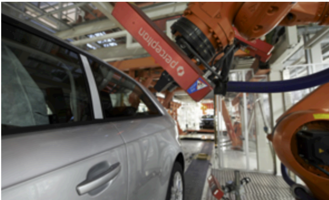
Figura 21. Robot en línea midiendo Gaps & Flushness
