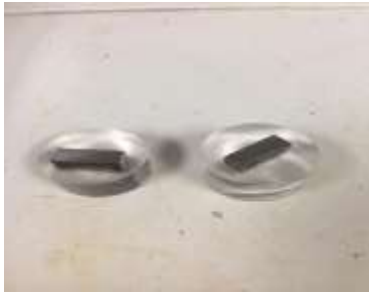
3.7. Muestras para observar con el microscopio.
