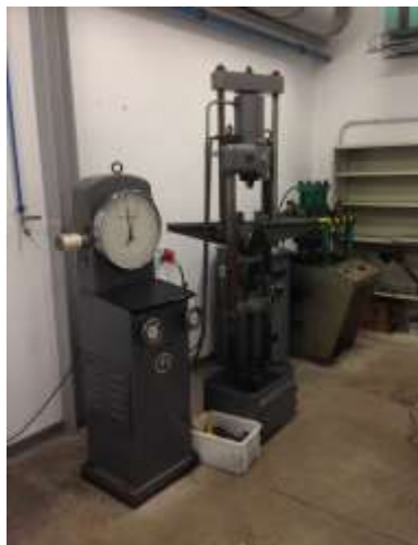
6.17. Máquina de ensayos a tracción y a flexión.
