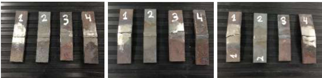
6.20. Probetas ensayadas a flexión.
