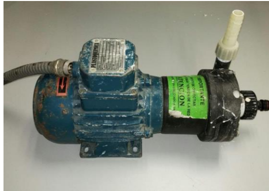
Figura 26 Bombas de vacío. Plastoquímica.
