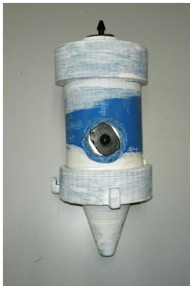
Figura 62 Prototipo con recubrimiento y teflón ensamblado
