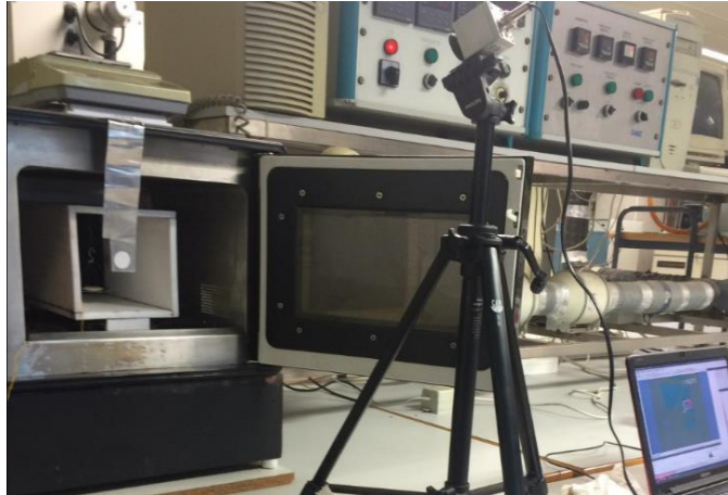
Figura 36 Detalle del equipo de cinética de secado
