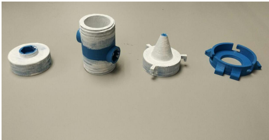
Figura 61 Prototipo Con el recubrimiento aplicado y el teflón
