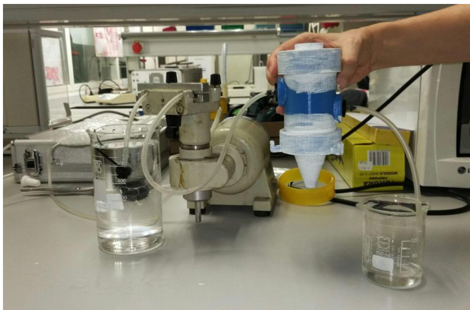
Figura 64 Ensayo del sistema de refrigeración
