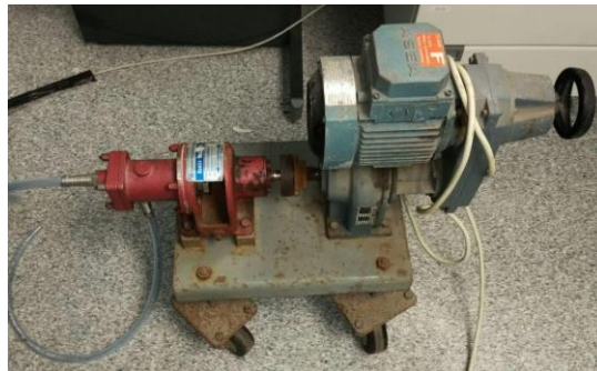
Figura 27 Bombas de vacío "CompAir-Mono Pumps Ltd. ASEA
