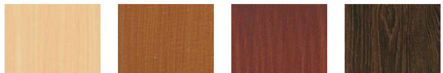
Fig 236. Acabados de los barnices sobre el haya (de izq. a drcha.): natural, caoba, cerezo y nogal
