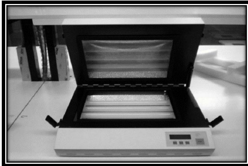
Fig. 39 Insoladora para revelar las pistas sobre la placa fotosensible
