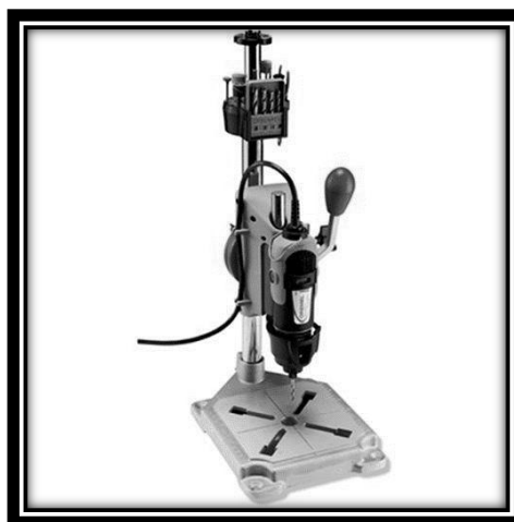
Fig. 42 Dremel de banco usada para taladrar las PCB
