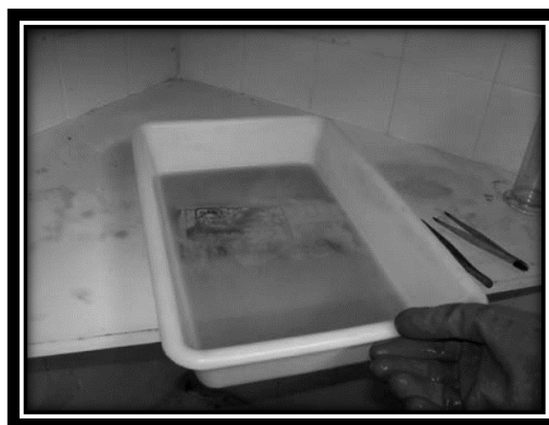
Fig. 40 Atacado químico de las placas para eliminar el cobre sobrante
