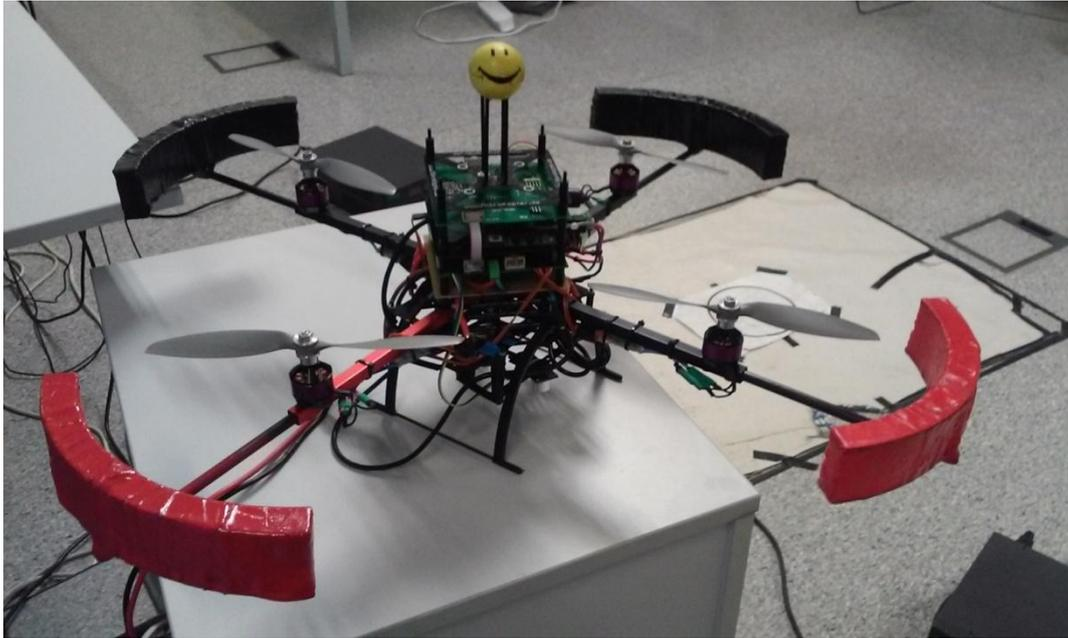
**Ilustración 5. RPAS utilizado en el laboratorio para la validación experimental.**
