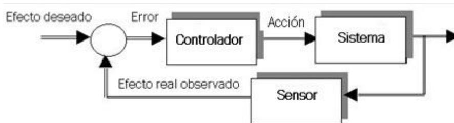
Esquema 3. Bucle de control del modelo de referencia.
