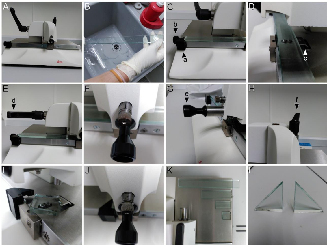
Figura 6 - Cortador de barras de vidrio (A), barra de vidrio entera (B) y cortada (K), partes del cortador (C-J) y cuchillas de vidrio (L). Las diferentes partes y su funcionamiento se describen en el texto.
