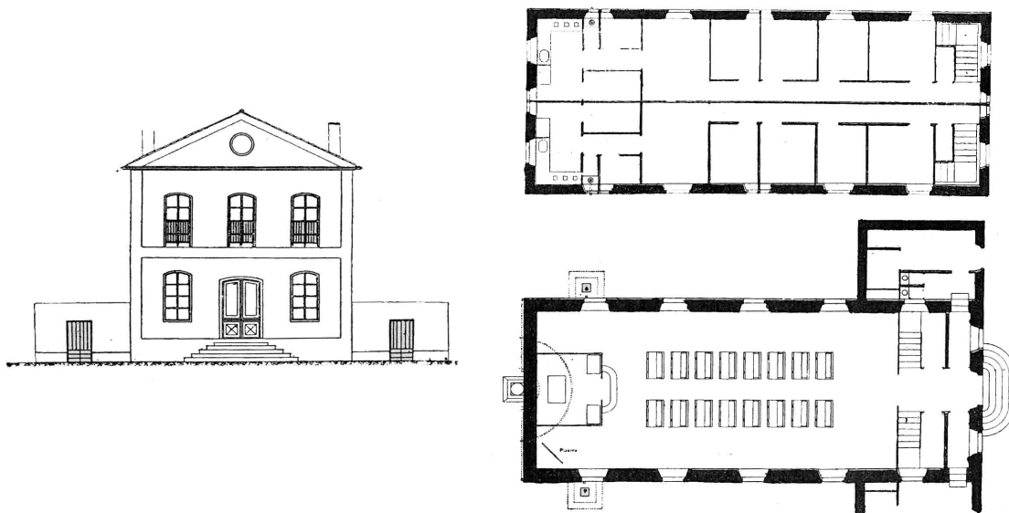
Fig.2.4.3.3.4. Plantas y alzado principal del edificio correspondiente a la escuela y viviendas del maestro y vicario. En planta baja, la escuela; en planta primera, las viviendas. JUNTA CENTRAL DE COLONIZACIÓN Y REPOBLACIÓN INTERIOR (1924). Sucinta información de las colonias agrícolas instaladas y en período de establecimiento o estudio que publica la Junta Central de Colonización y Repoblación Interior . Madrid: Gráficas Reunidas, p. 51.
