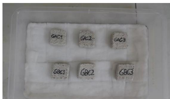
Fig. 17. Inicio de la prueba absorción de agua por capilaridad
