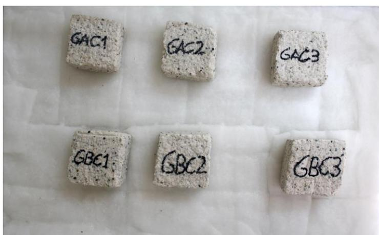
Fig. 25. Estado de las probetas tras 44 horas de absorción de agua por capilaridad
