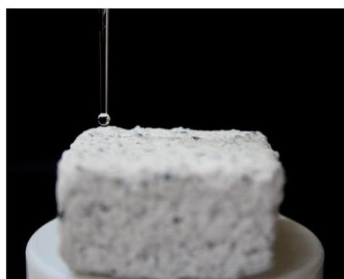
Fig. 16. Inicio de la prueba de absorción por gota de agua.
