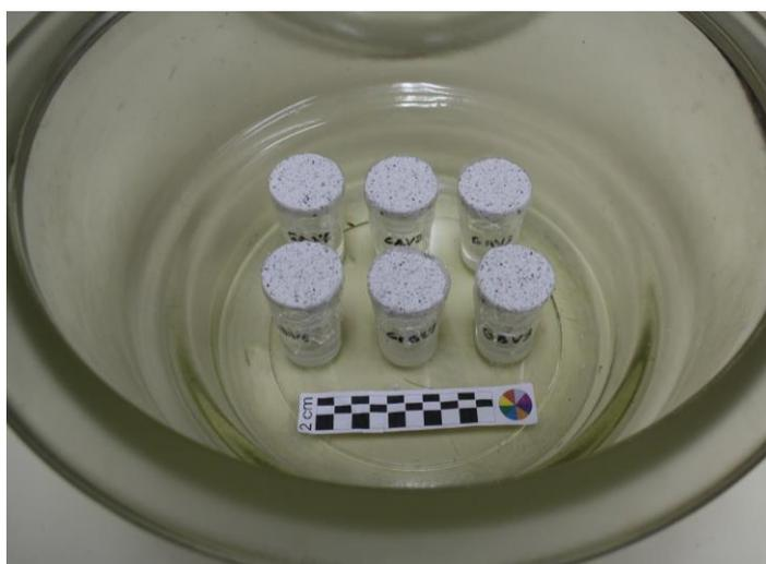
Fig. 18. Proceso de la prueba de permeabilidad al vapor de agua
