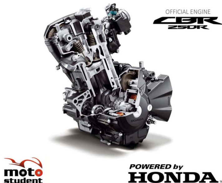
Ilustración 20 Motor Honda CBR 250R suministrado por la organización
