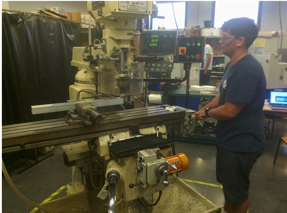
Ilustración 73 Mecanizado de los brazos del basculante por fresado manual
