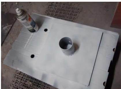
Imagen 19. Imprimación de la pieza.
