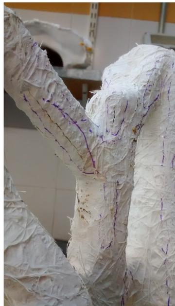
**Imagen 35.** Rotura en la cáscara cerámica de 3er grado.
