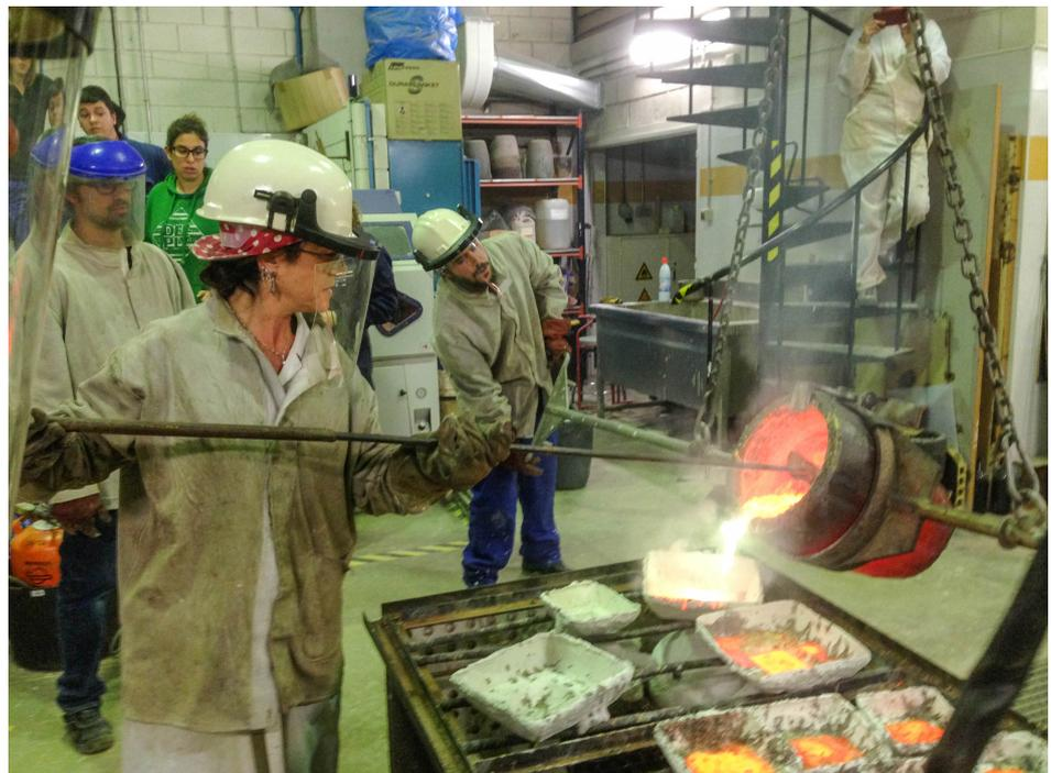
Imagen 38. Equipo de fundidores realizando una colada.
