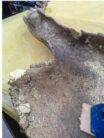
Imagen 50. Detalle de los bebederos tras el corte.
