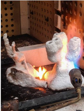
**Imagen 34.** Descere mediante choque térmico.
