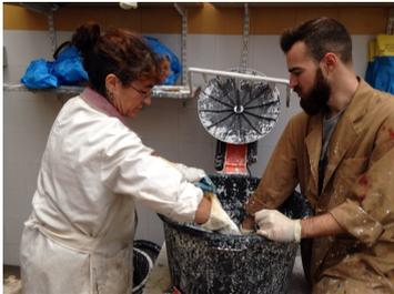
**Imagen 31.** Aplicación de la papilla a la pieza.
