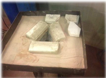
Ilustración 22. Quemador de alta alúmina de la fragua
