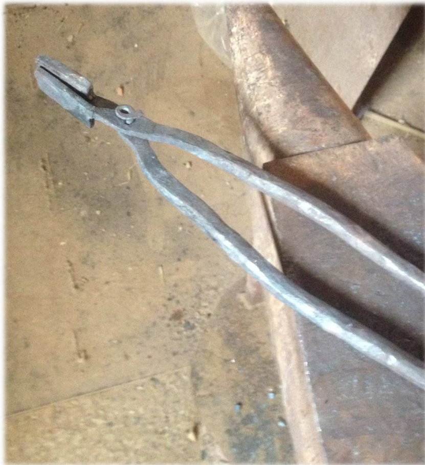
Ilustración 37. Tenazas en proceso de forjado.
