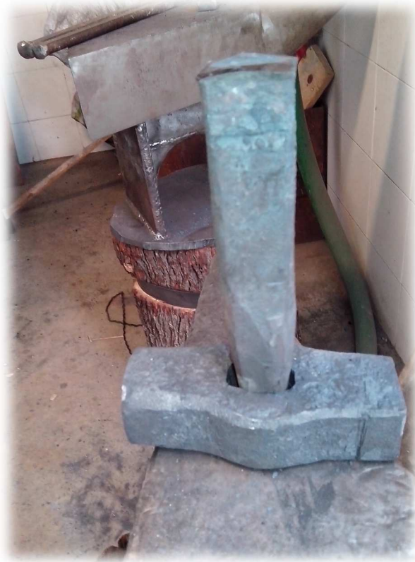
Ilustración 34. Ensanchando el ojal del martillo.
