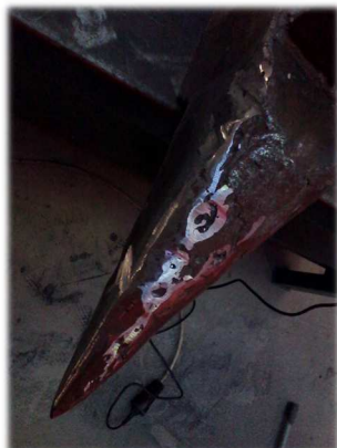
Ilustración 13. Desbastado de la bigornia
