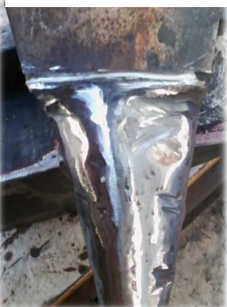
Ilustración 14. Desbastado de la bigornia
