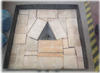
Ilustración 20. Base aislante de la fragua
