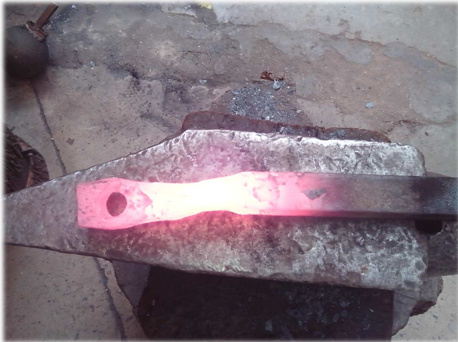
Ilustración 32. Modelando la cabeza de uno de los martillos.
