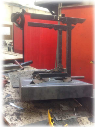
Ilustración 19. Soldando las patas de la fragua
