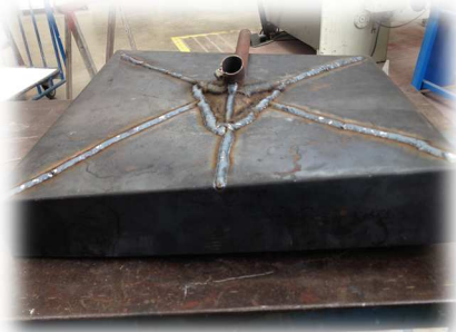
Ilustración 18. Caja de la fragua combada por el calor de las soldaduras
