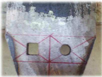
Ilustración 10. Ojales del yunque terminados.
