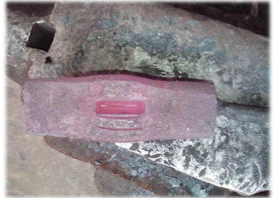
Ilustración 23. Realizando el ojal del martillo
