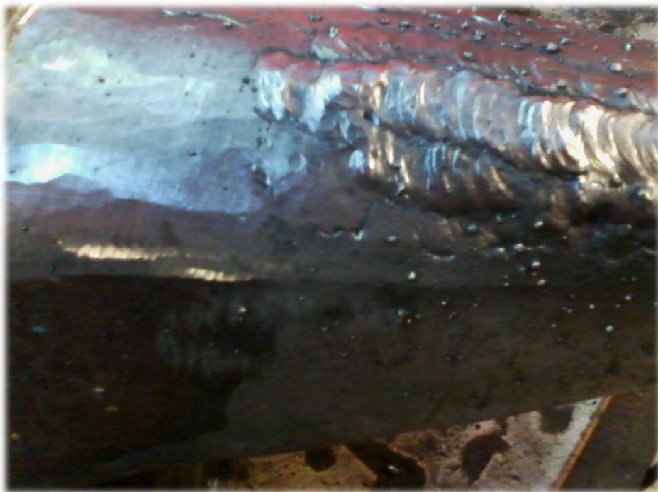
Ilustración 29. Rellenando los poros de la bigornia.
