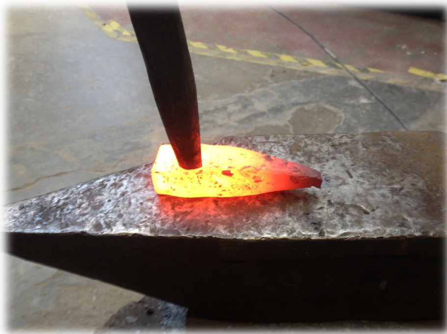
Ilustración 33. Realizando el ojal de uno de los martillos.
