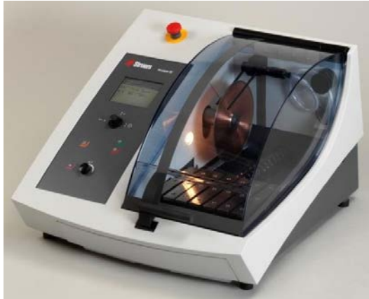
Figure 17. Cortadora automática de precisión (instituto de tecnología de materiales UPV)
