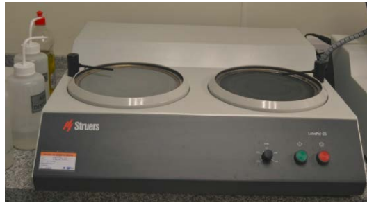
Figure 19. Desbastadora de discos de velocidad variable (Instituto de tecnología de materiales UPV)
