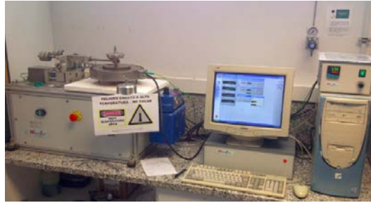
Figure 24. Tribómetro de alta temperatura en configuración de bola sobre disco (instituto de tecnología de materiales UPV)
