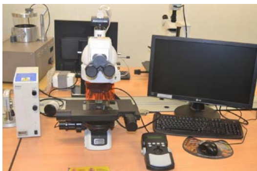
Figure 21. Microscopía óptica de mesa electrónica y cambio de lentes automático (instituto de tecnología de materiales UPV)
