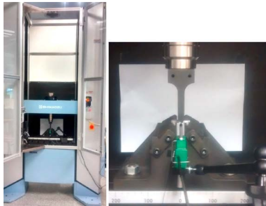
Figure 22. Máquina universal de ensayo de 50 kN y detalle del dispositivo de deflexión con el deflectómetro instalado (instituto de tecnología de Materiales UPV)
