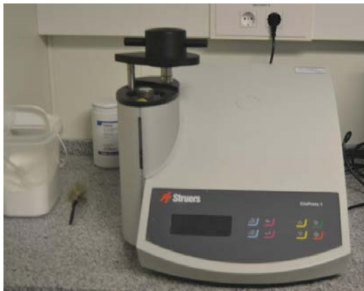
Figure 18. Embutidora automática de muestras (instituto de tecnología de materiales UPV)
