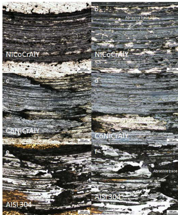
Figure 50. Huellas MO después del ensayo a alta temperatura (a-c-e) x50; (b-d-f) x100.
