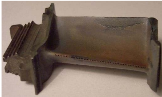
Figure 2. Álabes real de motor de reacción Turbo-Union RB199 luego de un tiempo en servicio [BOYCE MP, 2012].
