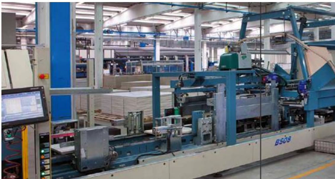
Figura 3.17 Línea de clasificación en industria cerámica
