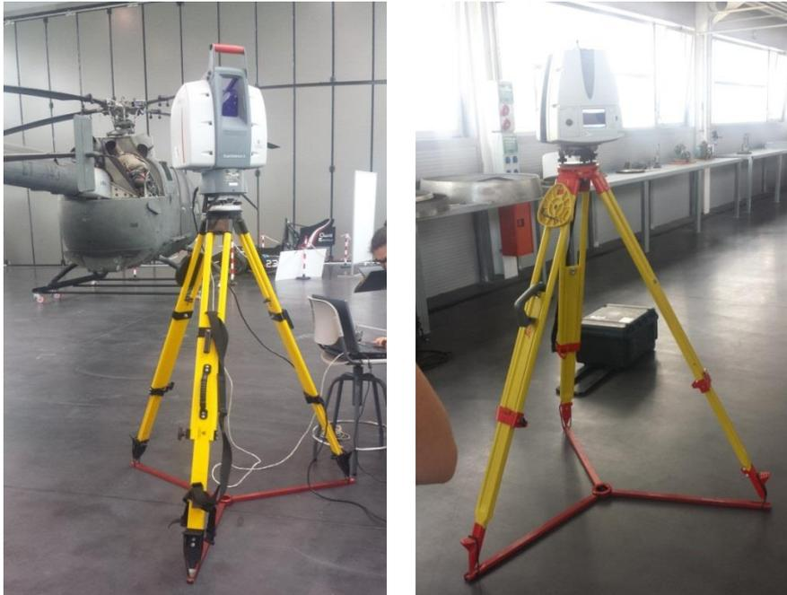
Figura 20: ScanStation 2 (izquierda) y ScanStation P40 (derecha) sobre sus trípodes
