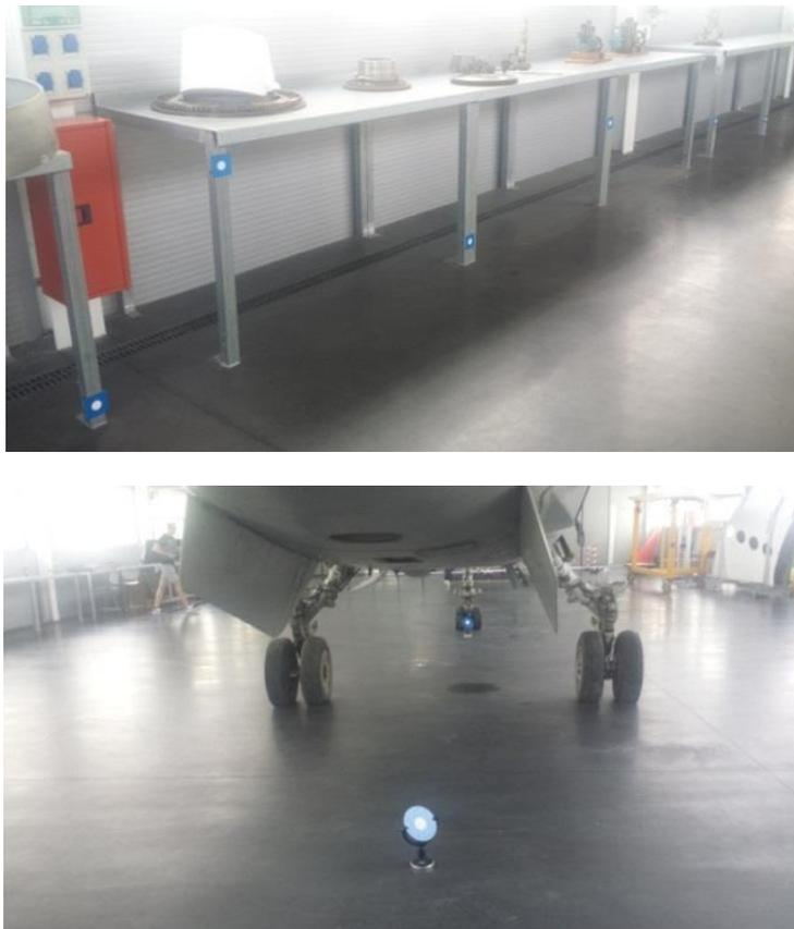
Figura 21: Distribución de dianas verticalmente en las mesas del laboratorio (superior) y en el suelo bajo el Mirage F1 (inferior)
