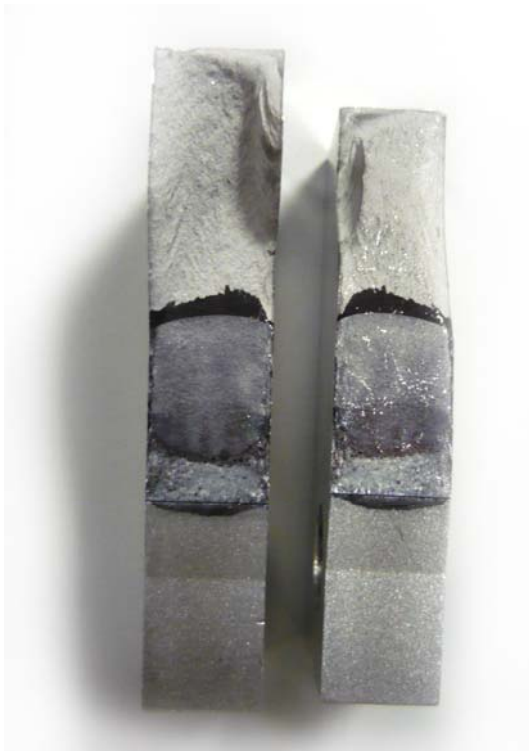
Imagen 11. Detalle pregrieta de fatiga y plano de fractura. Probeta de 12 mm de espesor.
