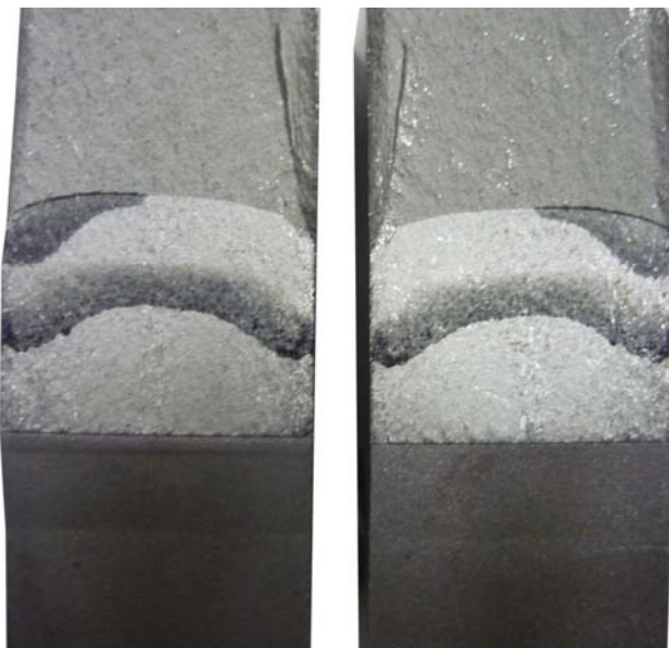
Imagen 13. Detalle pregrieta de fatiga y plano de fractura. Probeta de 24 mm de espesor.
