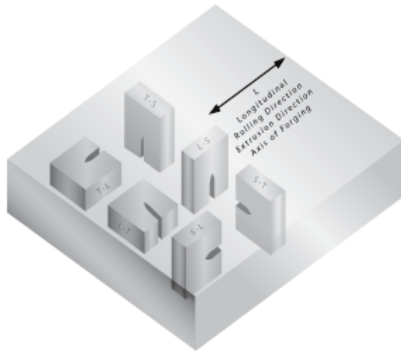
Figura 4.2.2. Notación de la normativa ASTM para probetas extraídas de placa laminada o forja.
