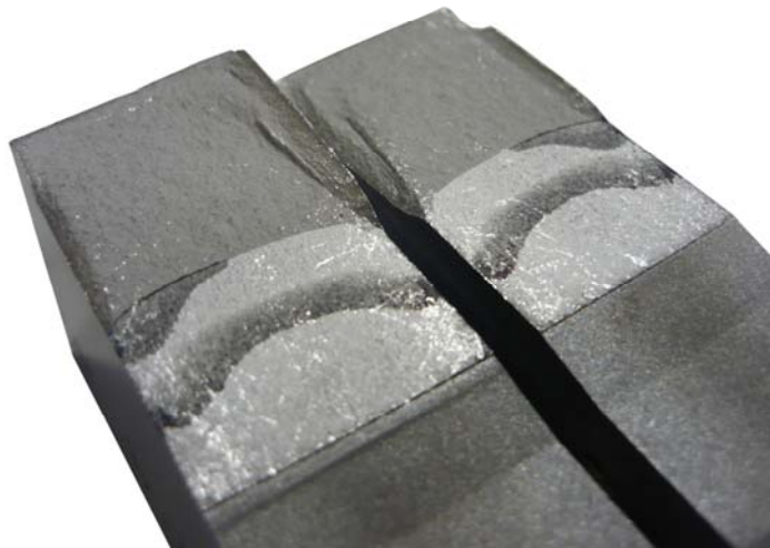
Imagen 12. Detalle pregrieta de fatiga y plano de fractura. Probeta de 24 mm de espesor.
