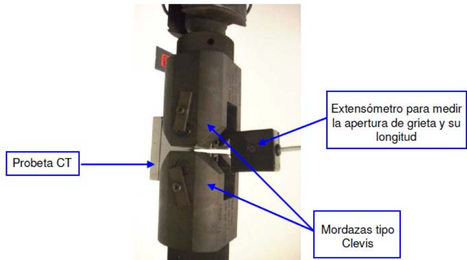
Figura 5.3.2. Montaje de la probeta y la instrumentación para medir la longitud de grieta.
