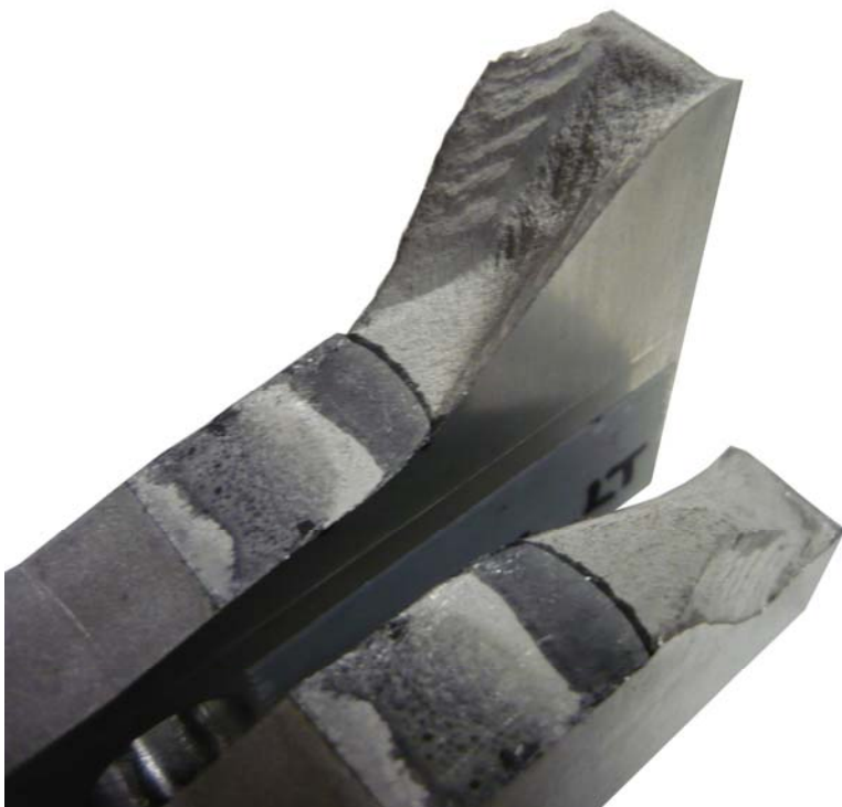
Imagen 9. Detalle pregrieta de fatiga y plano de fractura. Probeta de 12 mm de espesor.
