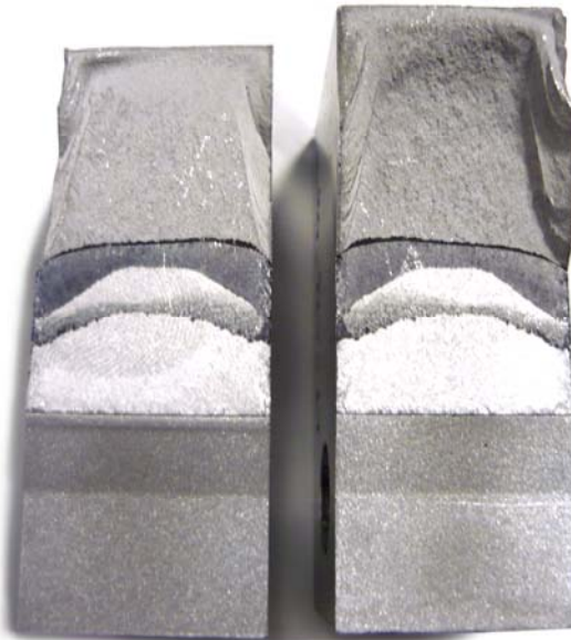
Imagen 15. Detalle pregrieta de fatiga y plano de fractura. Probeta de 24 mm de espesor.
