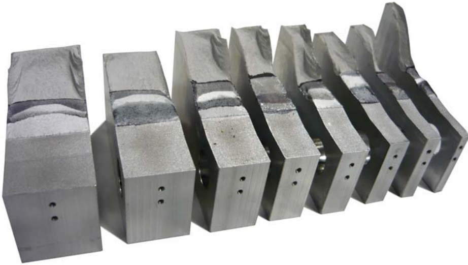
Imagen 1. Fotografía general de probetas fracturadas. Diferentes espesores.
