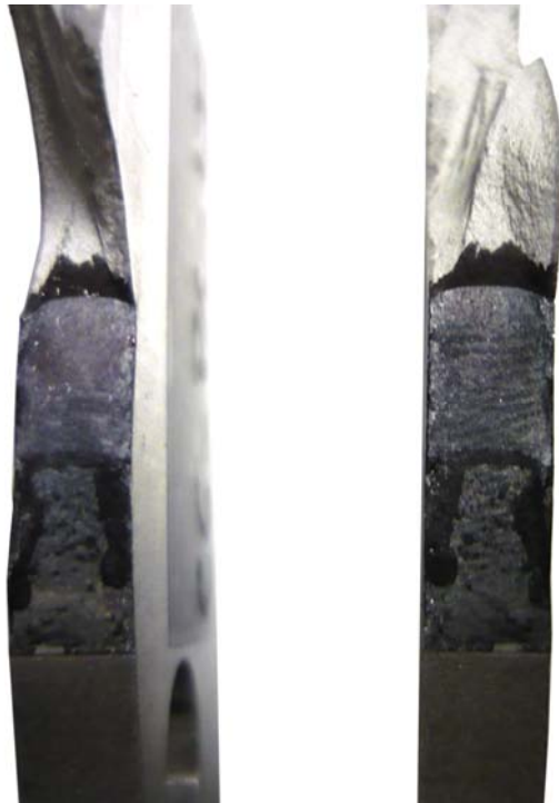
Imagen 5. Detalle pregrieta de fatiga y plano de fractura. Probeta de 6 mm de espesor.
