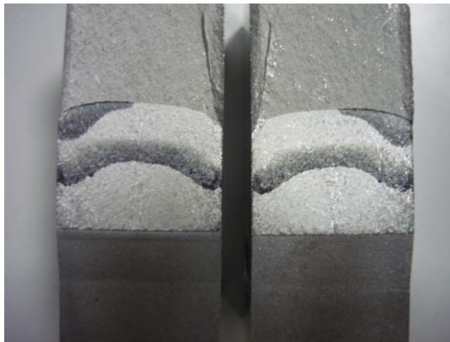
Figura 5.3.4. Fotografía de detalle de la pregieta de fatiga de la probeta ensayada.
