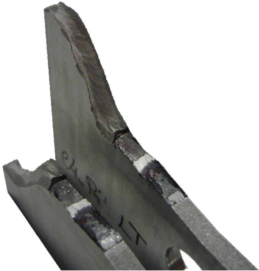
Imagen 3. Detalle de plano de fractura. Probeta de 4 mm de espesor.
