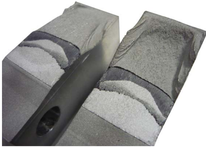
Imagen 14. Detalle pregrieta de fatiga y plano de fractura. Probeta de 24 mm de espesor.
