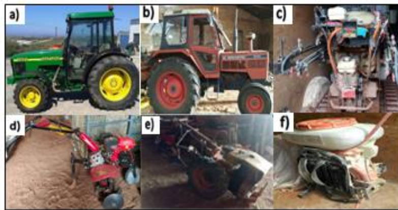
Figura 7. Maquinaria empleada en campo: a) Tractor John Deere 5510, b) Tractor Same Mercury 85, c) Oruga, d) Motoazada, e) Motocultor, f) Mochila motorizada.
