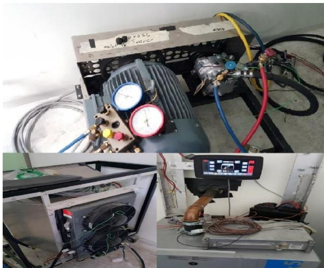
Figura 21 Elementos Restantes Sistema Climatización Cabina
