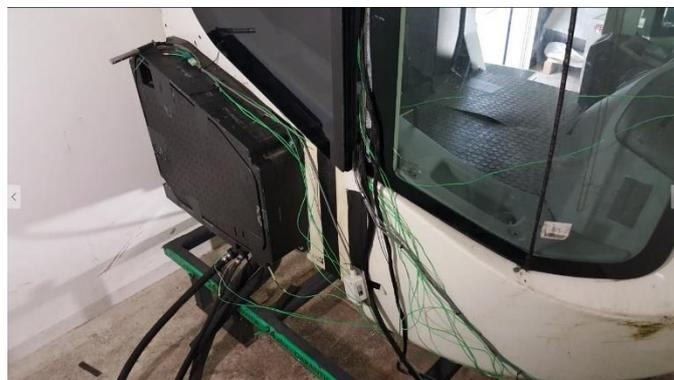
*Figura 20 Sistema Climatización Cabina*
