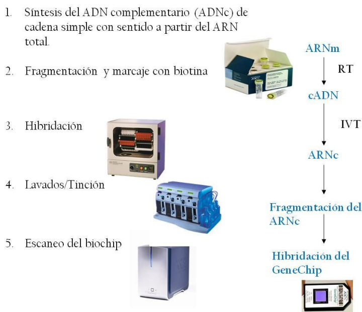
Figura 10: Esquema de un protocolo típico de un biochip de expresión de Affymetrix.
