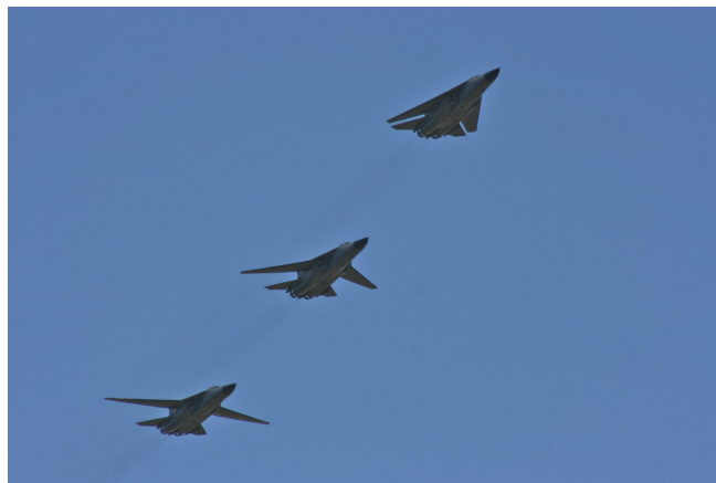
Figura 1.2: Avión F-111. Primer avión de geometría variable puesto en producción que entró en servicio el año 1967, diseñado por General Dynamics
