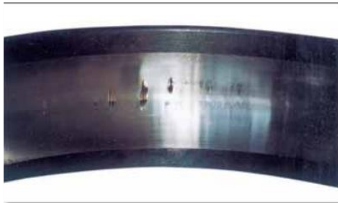
FIGURA 8. Desgaste en pista por vibración de origen externa. [6]
