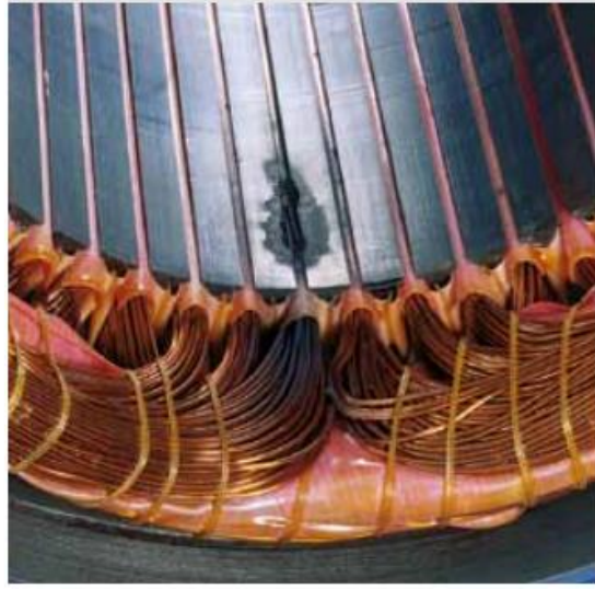
FIGURA 13. Cortocircuito en la ranura [7]
