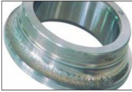
FIGURA 3. Lubricación deficiente provocada por la entrada de fluido de corte en el interior del rodamiento. [6]
