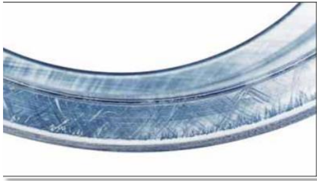
FIGURA 7. Ralladuras laterales en anillo interno por exceso de carga axial. [6]
