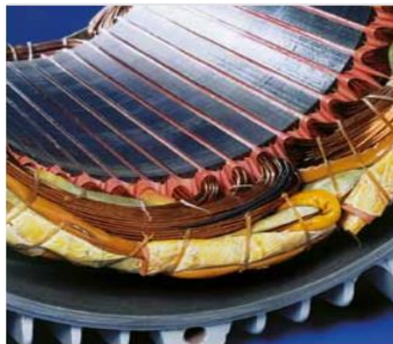
FIGURA 10. Cortocircuito entre espiras. [7]
