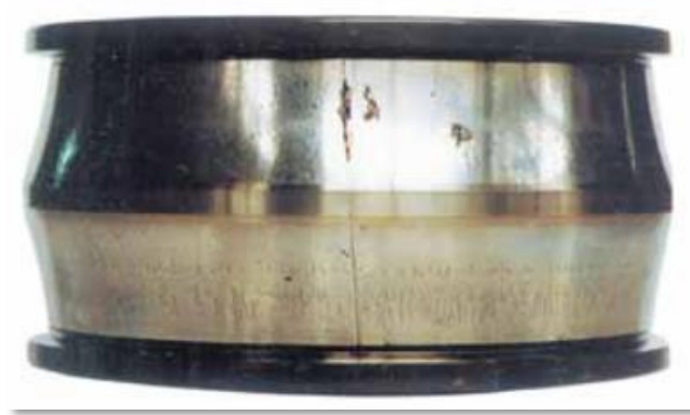
FIGURA 9. Ralladuras externas producto de la tensión de ajuste provocada por la diferencia de temperatura entre el anillo interno y el eje. [6]
