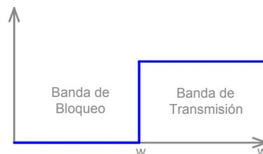
Longpass: Esquema de B. de transmisión y B. de bloqueo.
