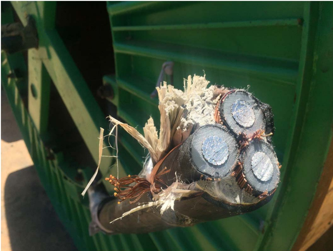
Figura 3.13: Cable de media tensión. 2KV, 1x240mm 2
