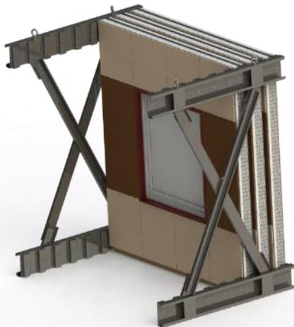
*Fig. 39. Cuadros de transporte de los paneles SPANS. Fuente: Elaboración propia.*
