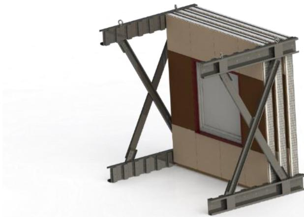
*Fig. 95. Visualización 3D de los "Boxes" de transporte compuestos por dos marcos metálicos con sistema de posicionamiento de paneles. Fuente: Elaboración propia.*
