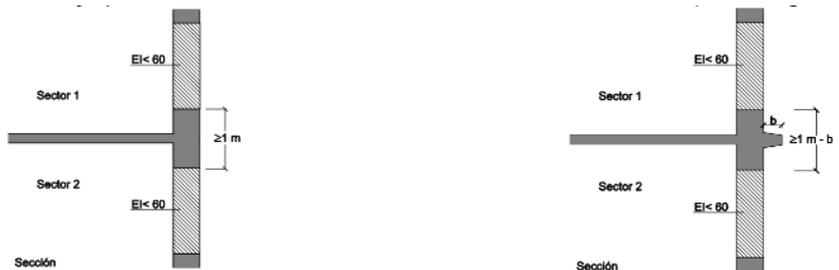
Fig. 29. Encuentro forjado – fachada (a la izquierda) y encuentro forjado-fachada con saliente (a la derecha). Fuente: Código Técnico de Edificación, 2014
