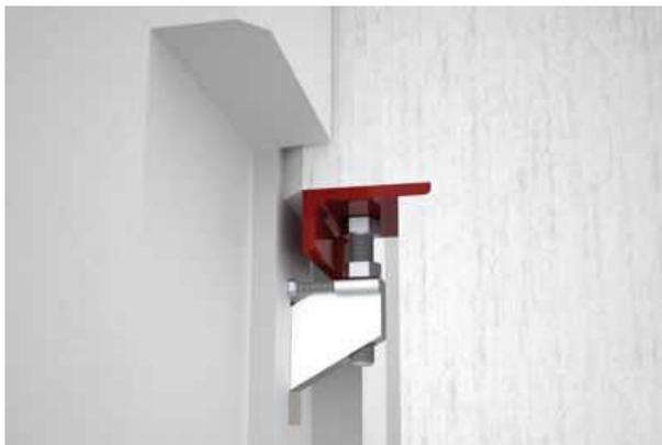
Fig. 20. Unión mecánica de apoyo entre paneles de hormigón y la estructura del edificio. Fuente:
