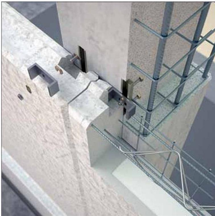
Fig. 19. Unión mecánica moderna entre los paneles de hormigón y estructura de edificio. Fuente: [http://www.tecnyconta.es/archivos/sfproductos/149pilares-hormigon-paneles-atornillado\\_01.jpg](http://www.tecnyconta.es/archivos/sfproductos/149pilares-hormigon-paneles-atornillado_01.jpg) Fecha de consulta: 03.03.2016
