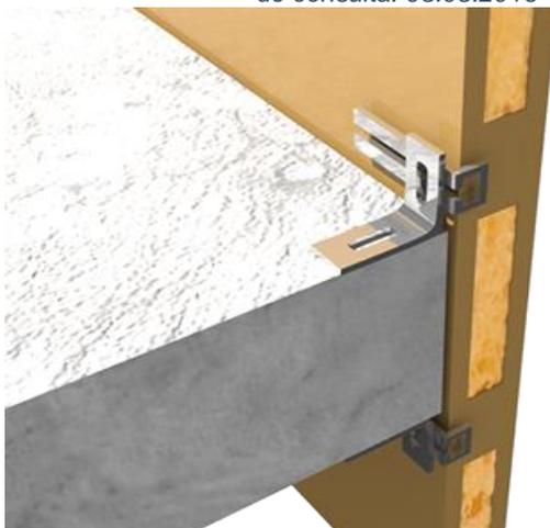
Fig. 21. La solución de la unión más habitual para paneles de GRC tipo sándwich. Fuente: <http://www.cimbrados.com/grc.html>. Fecha de consulta: 03.03.2016
