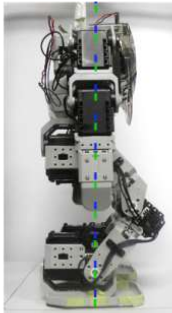
Ilustración 50 - Posición estable (Pitch)
