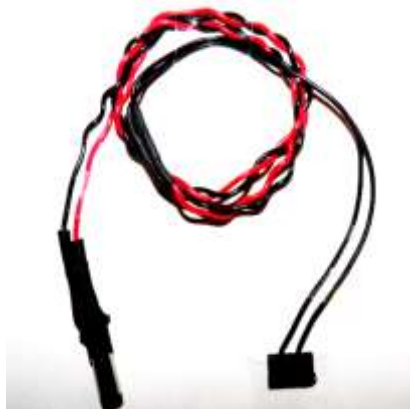
Ilustración 14 - Cable para la alimentación de la BeagleBone Black desde la CM-530
