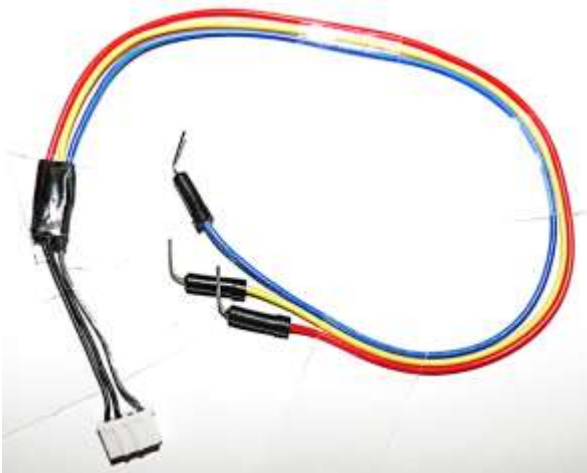
Ilustración 12 - Cable de comunicación entre la CM-530 y la BeagleBone Black
