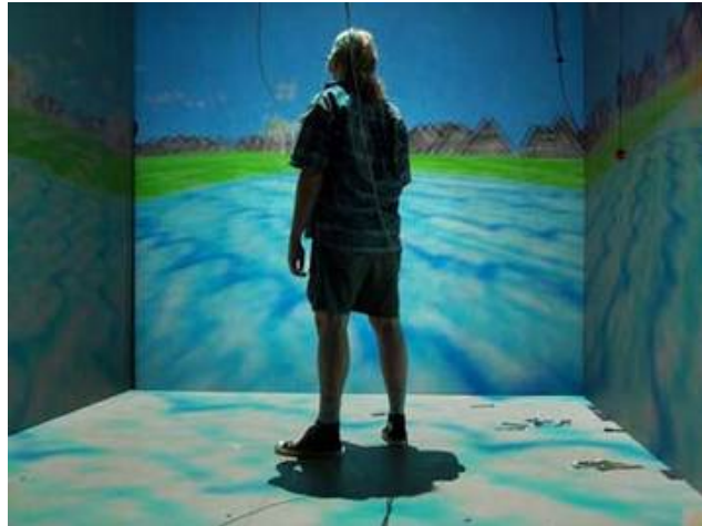
fig. 26 - tecnología Cave Assisted Virtual Environment (CAVE). Entorno de realidad virtual inmersiva desarrollado por científicos de la universidad de Illinois (Chicago) en el Electronic Visualization Laboratory, 1992
