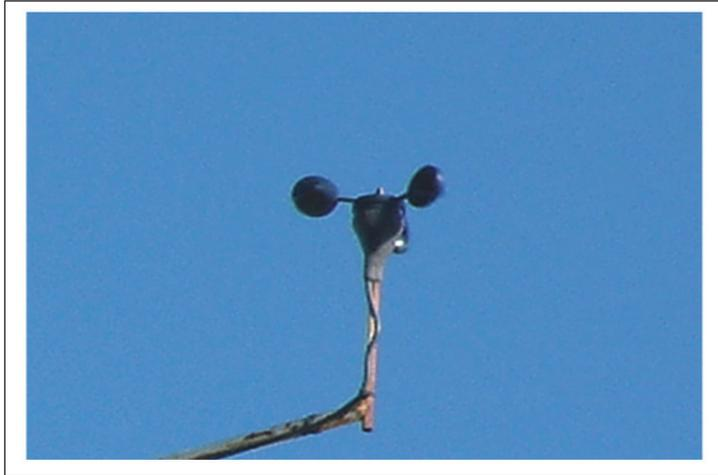
**Figura 2.6. Anemómetro de tres cazoletas. Fuente: elaboración propia**
