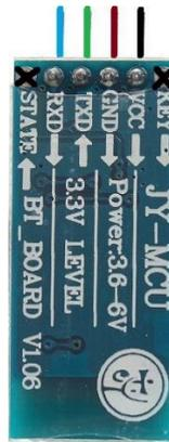
*Ilustración 22: Plano de conexión HC-06, identificación de colores con los pines*
