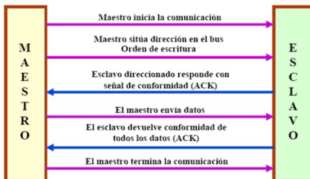
Ilustración 14: Diagrama de protocolo I2c, transmisión de datos Master-Slave
