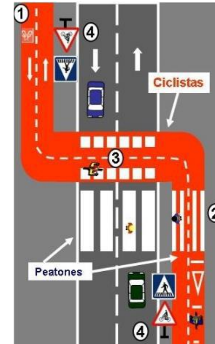
Imagen 4. Paso de peatones con carril bici y calzada. (Fuente: Normas para el uso de la bici.)
