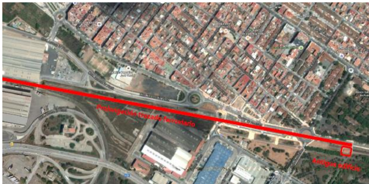
Figura 44. Alternativa 2 para la situación de la estación del FFCC en el Puerto de Sagunto. Obtenida del estudio funcional.
