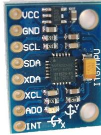
Figura 3.4 Módulo basada en el IMU digital MPU6050
