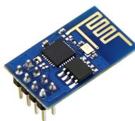
**Figura 3.12** Módulo Wi-Fi ESP8266
