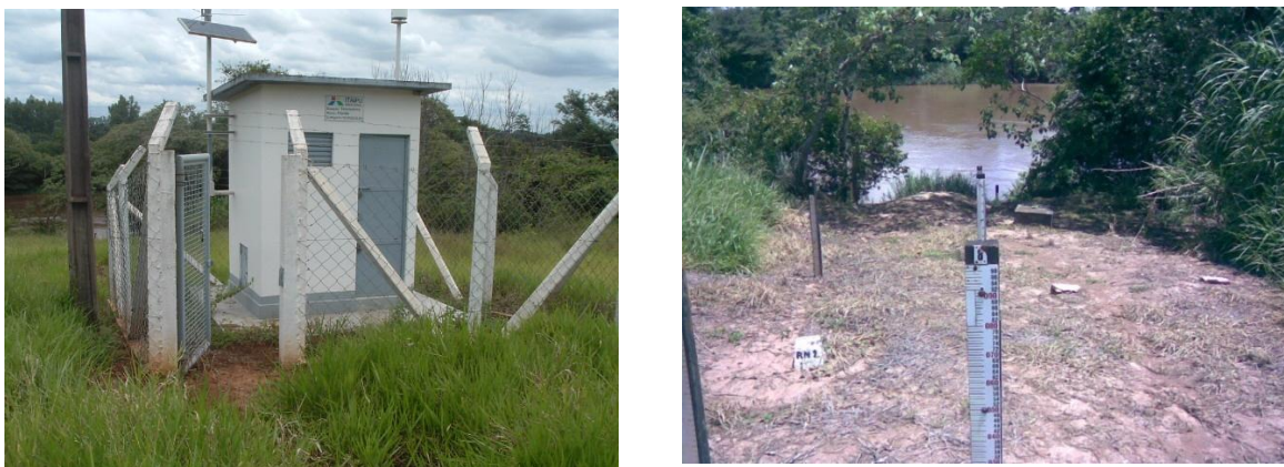
Figura 30 Estación hidrometeorológica Florida y lance de reglas limnimétricas.
