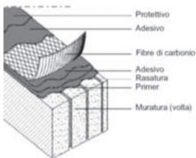
Consolidamento di volta a crociera con nastri in FRP e frenelli, esempi e applicativi.
