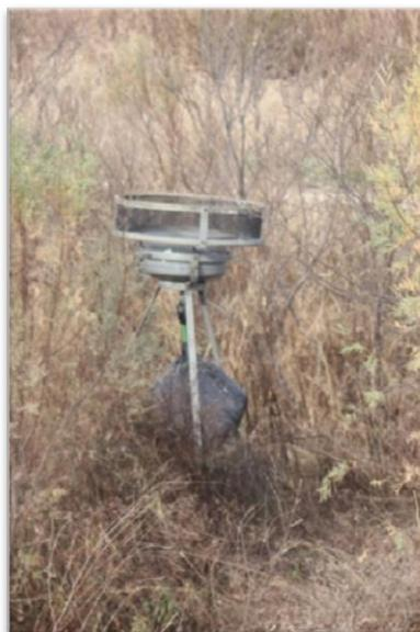
Figura 4.9. Imagen del captador atmosférico, ubicado en las proximidades del canal de salida.
