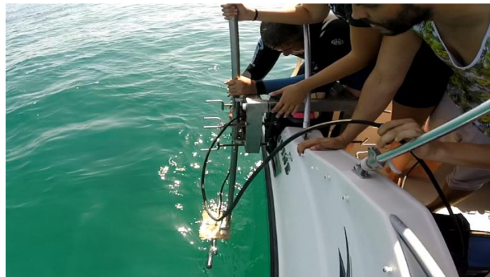
Figura 8. Colocación del transductor en el soporte.
