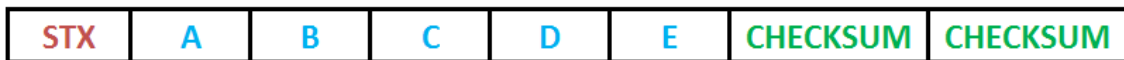
Figura 6.1: Estructura de un paquete de datos enviado desde el programa Matlab a la aeronave
