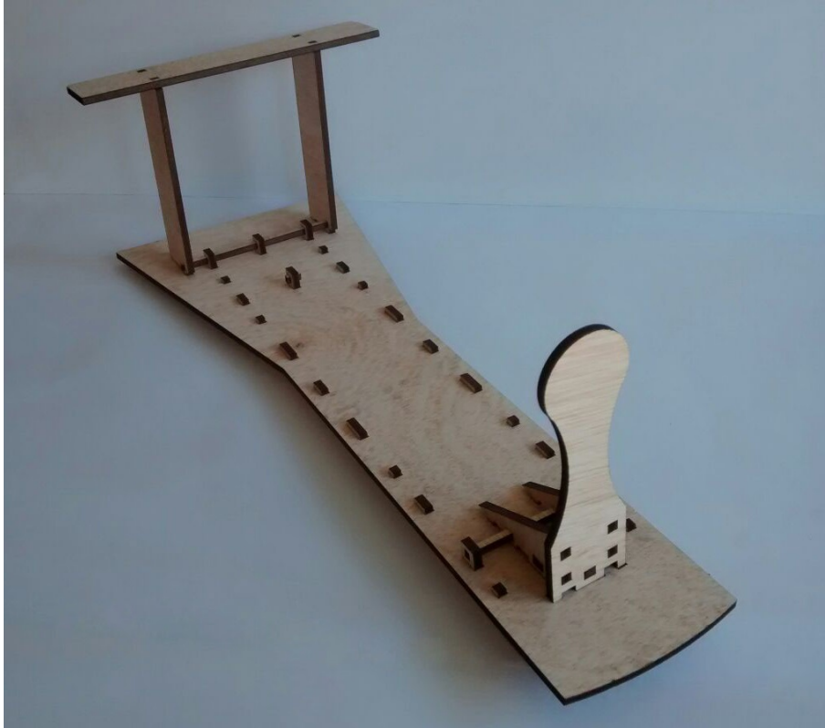
Figura A.7: Montaje previo de estructura de contrachapado
