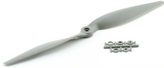
Figura A.24: Hélice de 6×5.5” con anillas para ajustar a diferentes ejes
