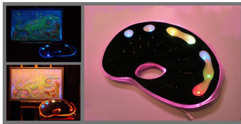
Figura 4 Controlador L'Orella Controlador para lámpara de amplio espectro lumínico. Dispositivo que permite mezclar las luces y visualizar el resultado de la luz de la lámpara en el propio dispositivo, monitorizándola.
