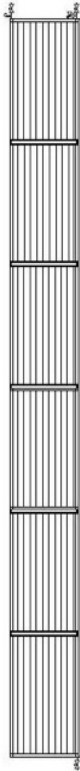
LONGITUD BATERIA DE 6 CAPTADORES: 12,186m.
