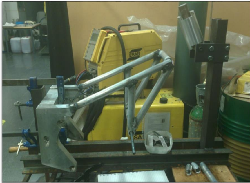
Figura 191. Colocación de la pipa de dirección
