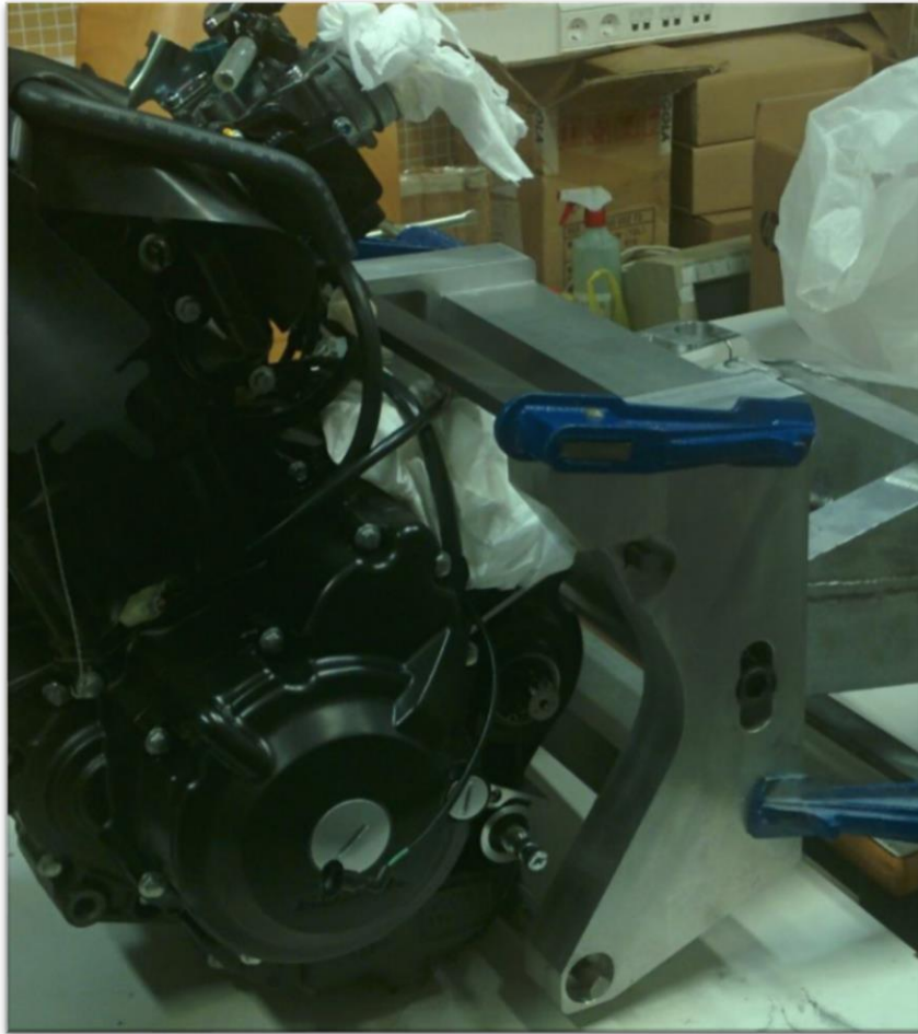
Figura 171. Ensamblaje del conjunto
