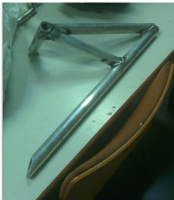
Figura 188. Cuatro primeros tubos soldados del lateral izquierdo
