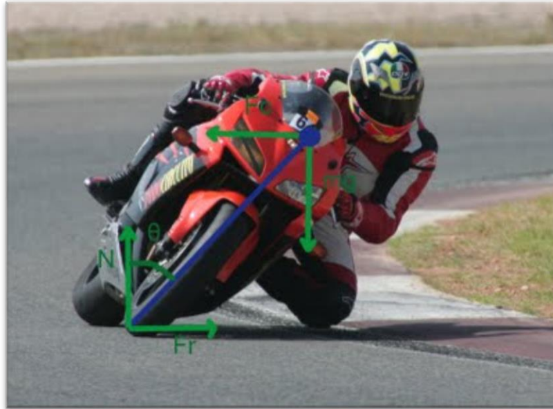
Figura 72. Fuerzas que actúan en el paso por curva
