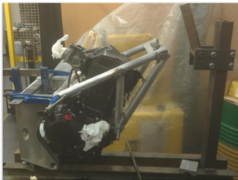
Figura 190. Colocación de los tubos sobre las pletinas
