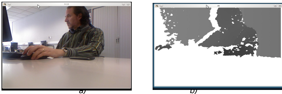
Figura 6: Salida las cámaras obtenida en ejemploBasic_OpenCV_Kinect : a) RGB y b) Distancias.
